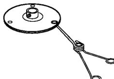
Flansch mit 3 x Schubstange 65 mm
