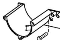
Motorhalterung für eine Fussmontage des Batteriemotors
